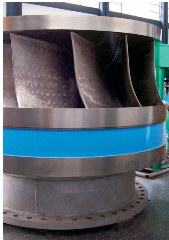
Vista del rotor de una de las turbinas francis.
