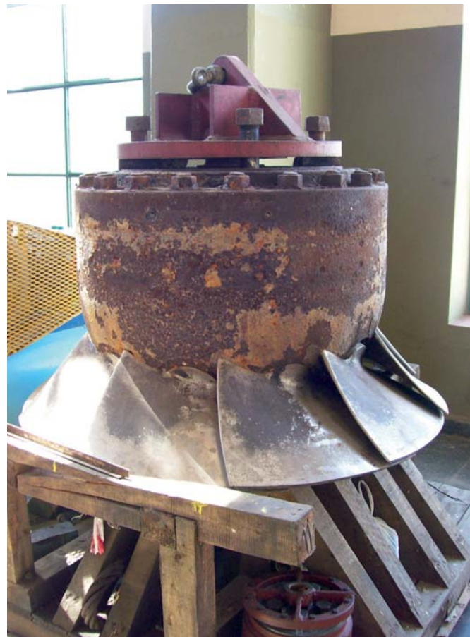
Vista del rodete de la turbina, tipo Deriaz.
