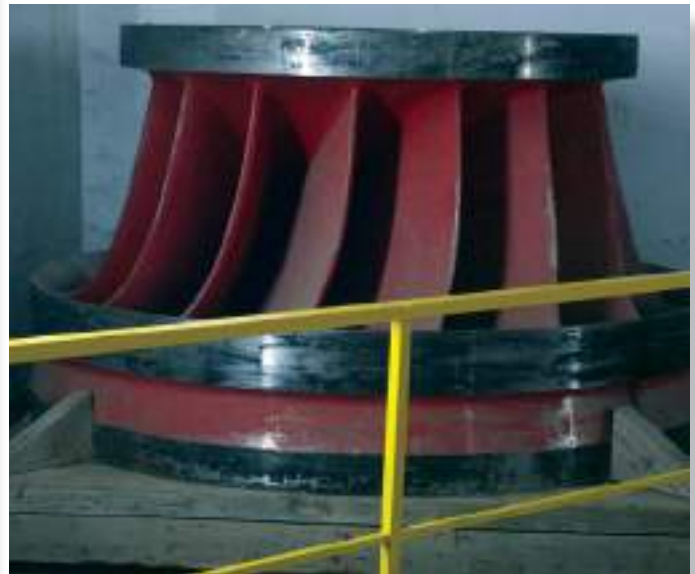
Vista del rodete de la turbina Francis.
