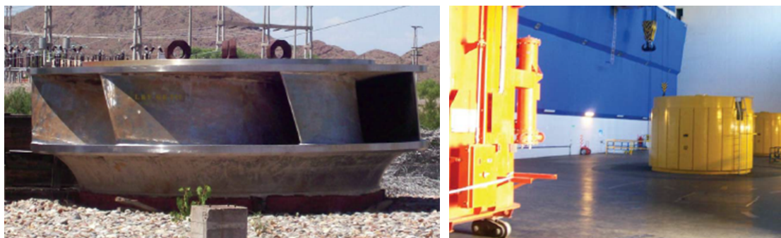
Figura 58. Vista del rodete de la turbina
