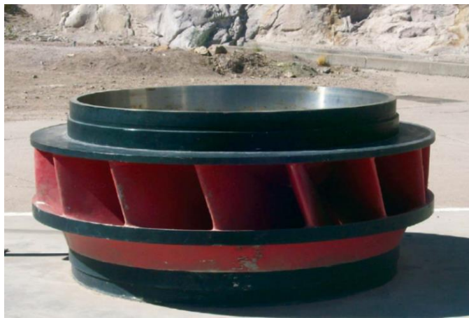
Figura 63. Rodete de una de las turbinas Francis de la central Nihuil II
