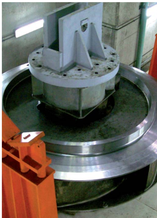
Figura 55. Vista de detalle de uno de los rodetes de las turbinas de la central de Cerro Pelado
