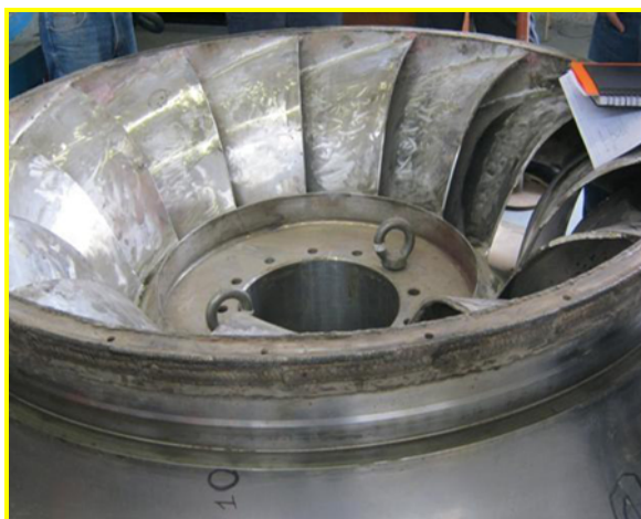
Figura 44. Erosión por cavitación.
