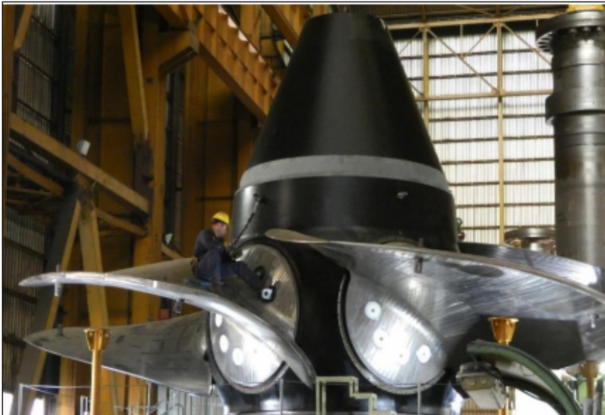
Figura 13. Rodete de turbina Kaplan
