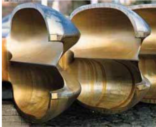
Figura 19: Cangilones o álabes de la turbina Pelton
