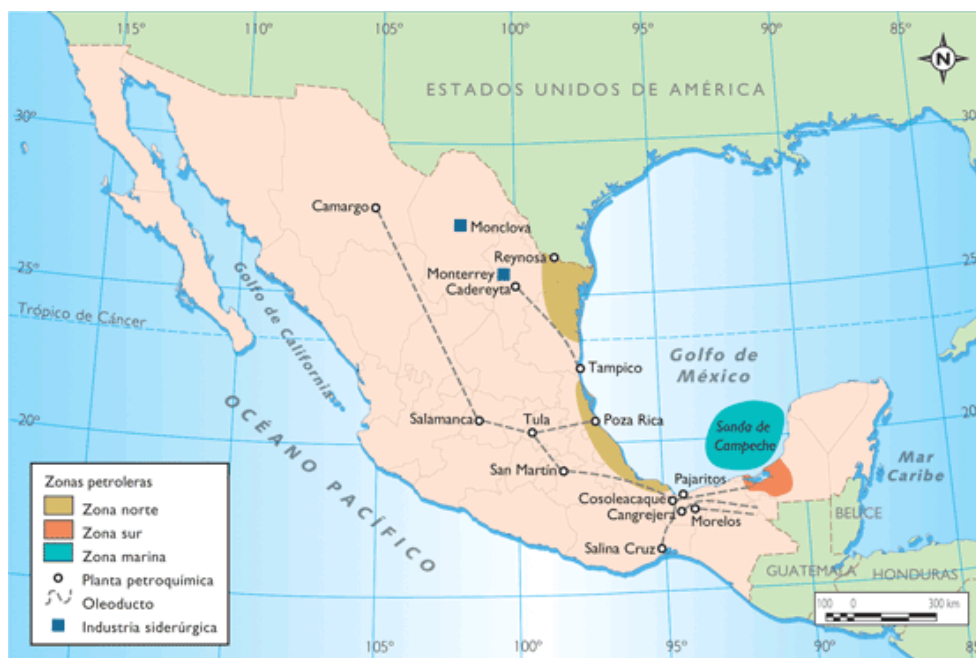
Ilustración 2 México: plataformas petroleras, plantas petroquímicas y oleoductos
