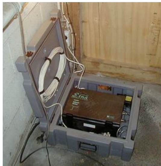
Fig. 8. (a) Esquema indicativo de los componentes de un sismógrafo, y (b) Acelerógrafo digital.
