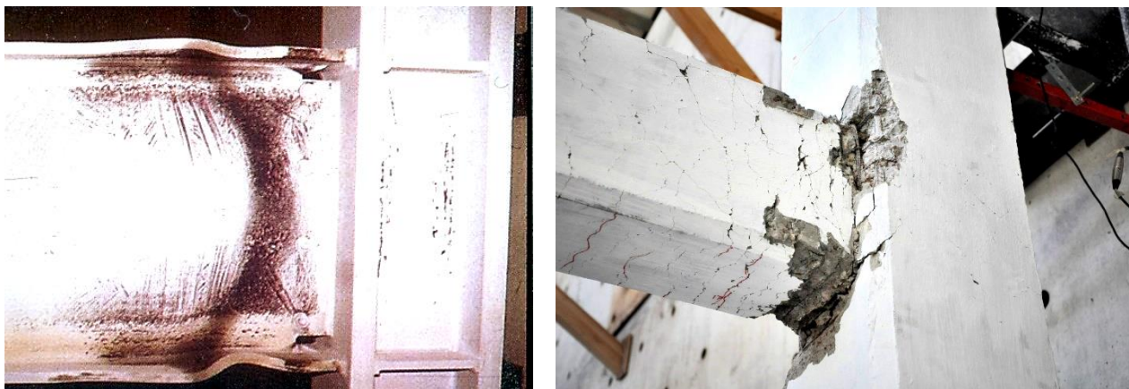
Figura. 21. Imagen de rótulas plásticas en el extremo vigas de acero y hormigón armado, ensayadas en el laboratorio.
