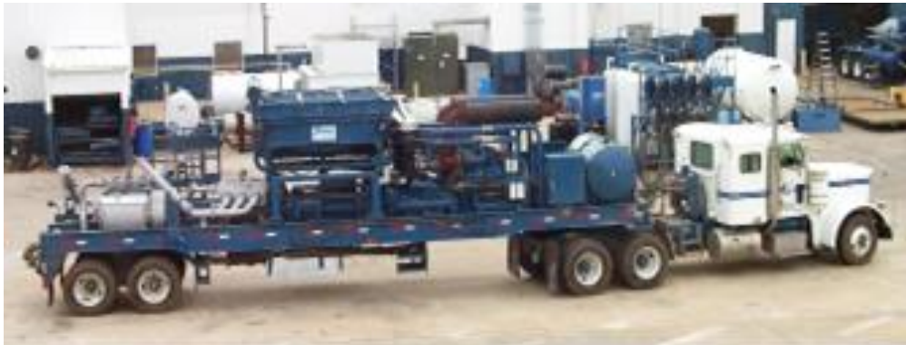
Fig.56. Bombas de Fractura
