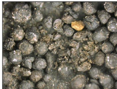
Fig. 34. Presencia de recortes (Crushing) del agente sostén, durante el ensayo de empotramiento
