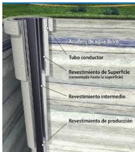
Fig.74. Aislación de zonas con casing
