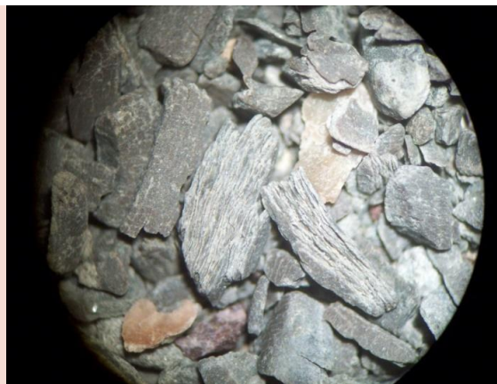
Foto Nro. 13: Recortes de Lutitas Bituminosas, de color gris oscura, en parte finamente laminada, Cuenca de Burgos, México (Foto J. Albeiro).
