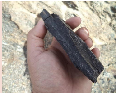
Foto Nro. 11: Muestra de mano de lutitas de la Formación Cacheuta, en el perfil del arroyo Divisadero Largo, provincia de Mendoza, Argentina. Se puede observar la fisilidad incipiente. (Foto: J. Albeiro, 2018).
